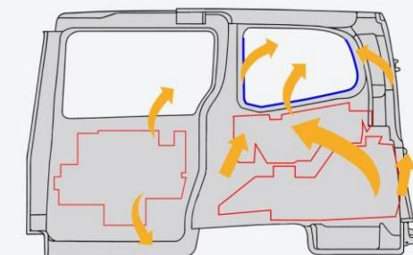
■：音の経路 ■：繊維系防音材設定エリア ■：防音シール材設定エリア
